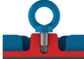
Рисунок 4.2 - Неправильное затягивание рым-болта
