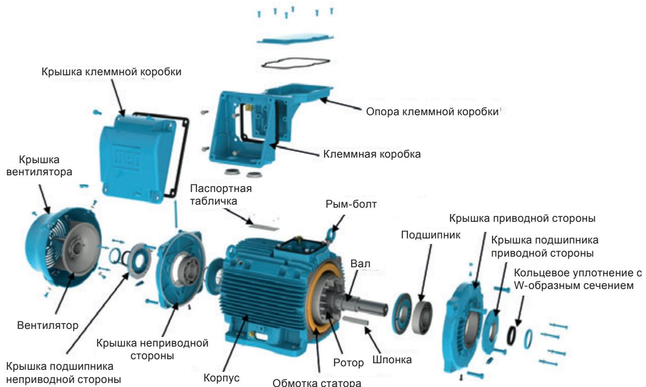
Рисунок 8.4 - Изображение электродвигателя серии W22 в разобранном виде
