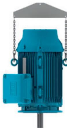
Рисунок 4.7 - Подъем электродвигателей вертикальной установки
