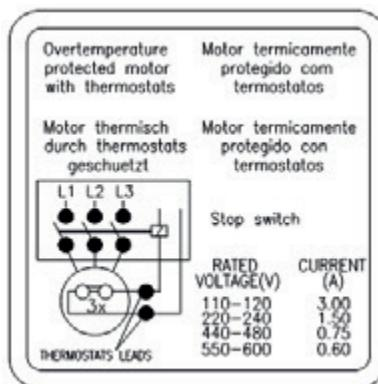
Рисунок 6.14 - Подключение биметаллических устройств тепловой защиты (термостатов)
