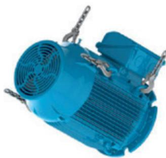
Рисунок 4.18 - Вращение двигателя в горизонтальное положение
