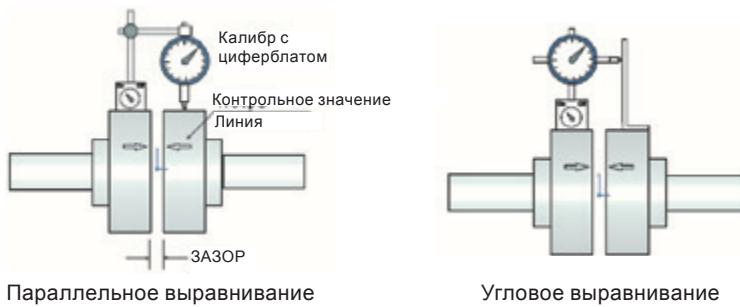
Рисунок 6.11 - Выравнивание с помощью калибра с циферблатом
