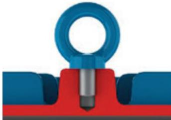
Рисунок 4.1 - Правильное затягивание рым-болта
