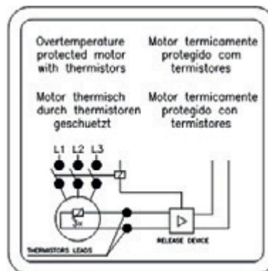
Рисунок 6.15 - Подключение термисторов
