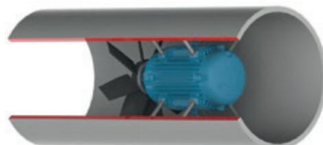
Рисунок 6.8 - Монтаж электродвигателя внутри воздуховода системы охлаждения
