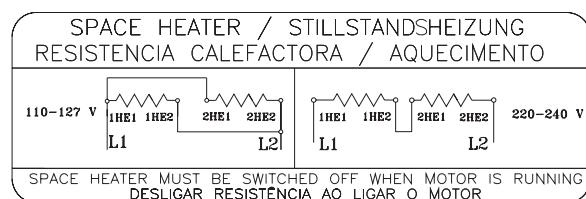
Рисунок 6.17 - Подключение нагревательных приборов двойного напряжения
