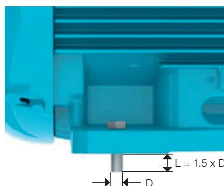
Рисунок 6.6 - Система монтажа электродвигателя, установленного на лапах
