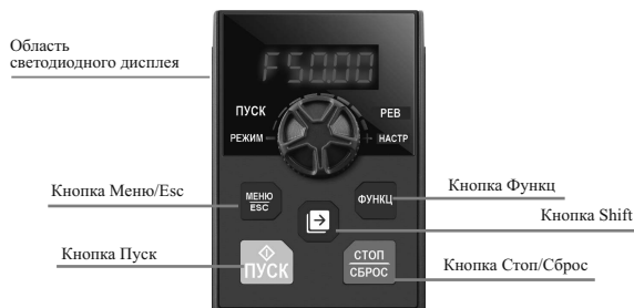
Рисунок 4-1 Встроенная светодиодная панель управления цифровым дисплеем (стандартная конфигурация, на съемной панели)
