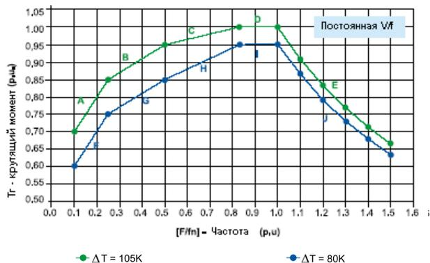
Рисунок 32 – Кривая зависимости номинальной мощности для постоянного потока
