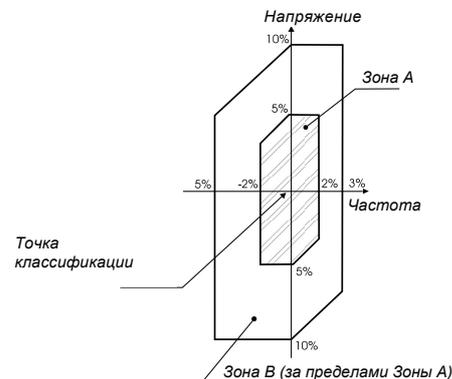
Рисунок 29 - Пределы номинального напряжения и частоты для электродвигателей
