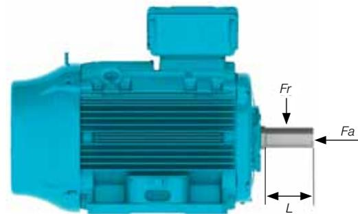
Рисунок 25 – Радиальная и осевая нагрузки на вал двигателя
